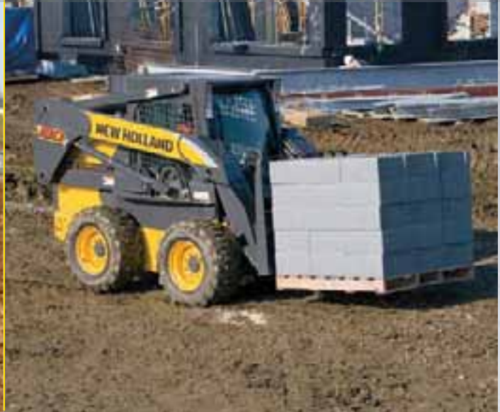
El modelo L180 se muestra con el accesorio de horquilla elevadora.
