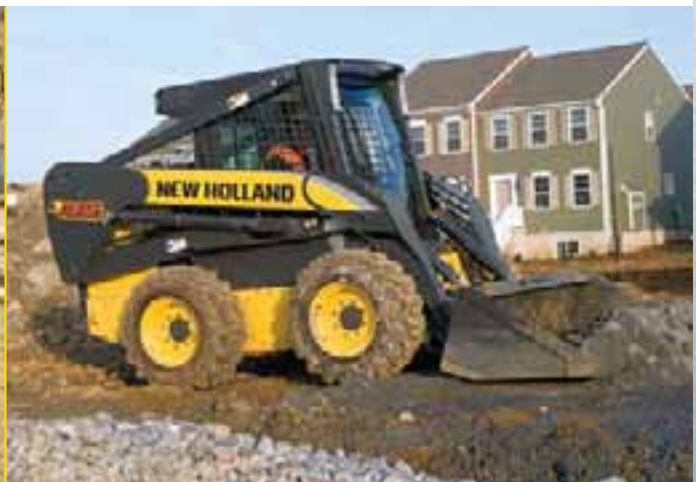
El modelo L185 se muestra con el accesorio de cucharón.
