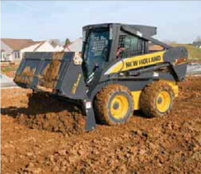
El modelo L190 se muestra con el accesorio de cucharón 4x1.
